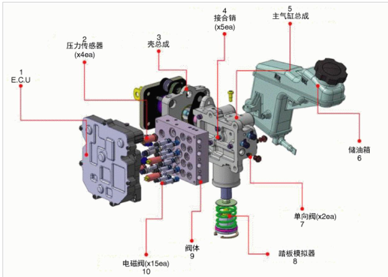
禁止分解集成制动驱动总成 (IBAU)。
